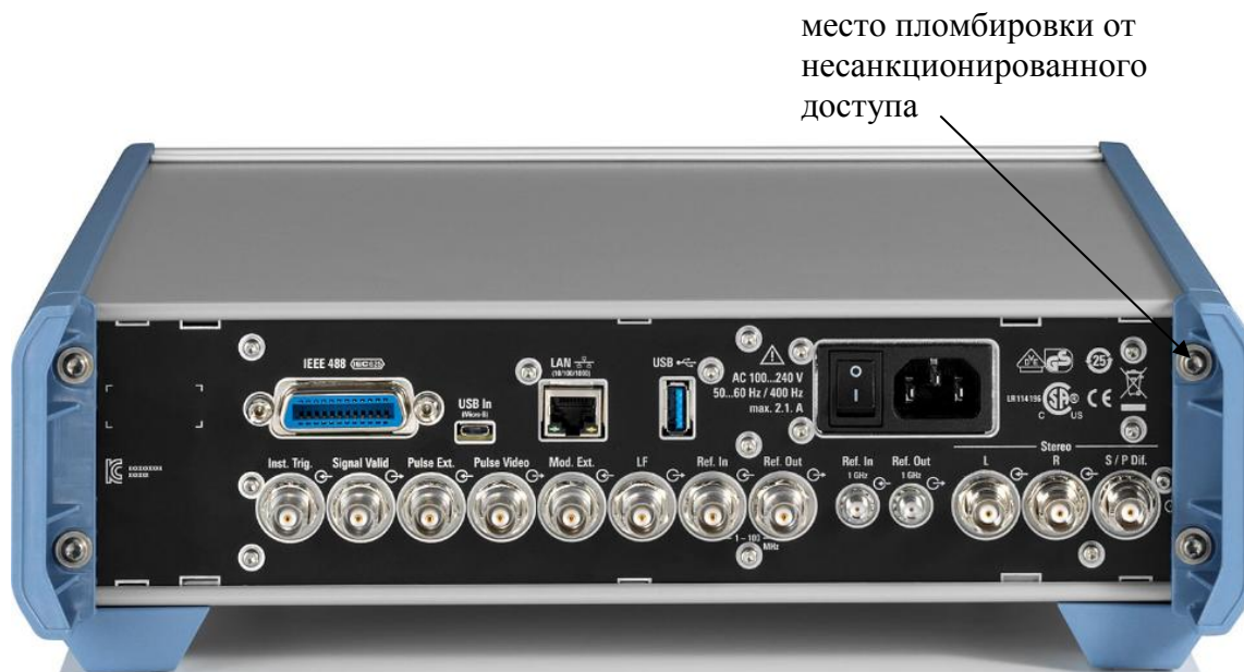
Рисунок 2 - Схема пломбировки от несанкционированного доступа
