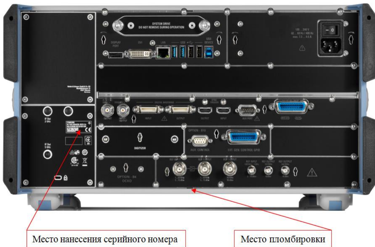
Рисунок 2- Схема пломбировки от несанкционированного доступа и место нанесения серийного номера СИ
