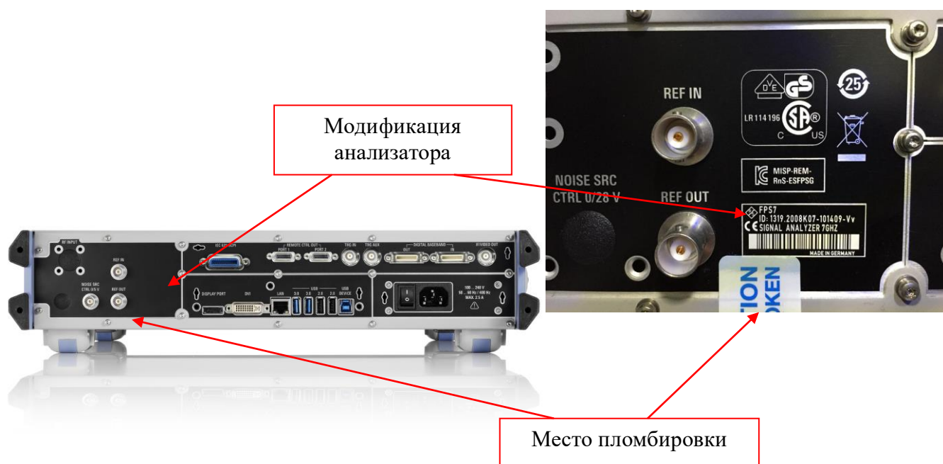
Рисунок 2 – Схема пломбировки от несанкционированного доступа и обозначение модификации анализаторов спектра FPS4, FPS7, FPS13, FPS30, FPS40
